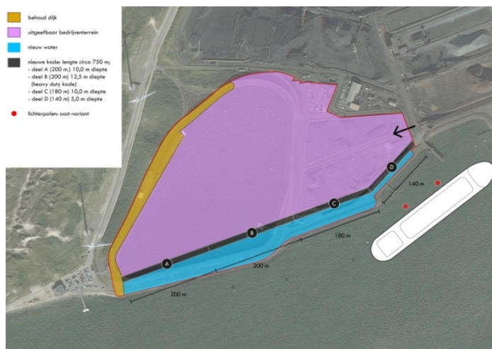
Figuur 2.2 Schematische weergave van projectalternatief 2 uit Dinkla en Bakker (2018) met in wit de lichterplaats.
